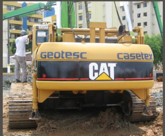
Hidraulic extended crawlers - Esteiras estendidas hidraulicamente
