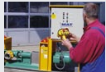
Exzentrerschneckenpumpe mit Fernsteuerung Eccentric Screw Pump with Remote-Control
