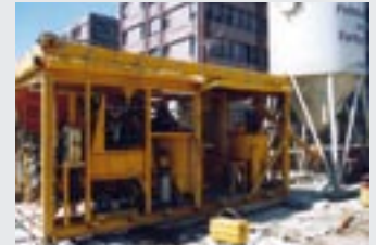
Vollautomatische, funktgesteuerte Injektionsanlage mit Chargenmischer SC-250 u. Injektionspumpe PP-180 Fully automated, radio controlled Injection Plant with Batch Mixer SC-250 and Injection Pump PP-180
