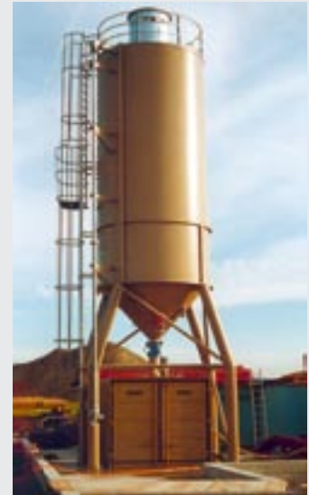
Durchlaufmischanlage SKC-60-C mit Bentonitsilo 50 m 3 Continuous Mixing Plant SKC-60-C with 50 m 3 Bentonite Silo
