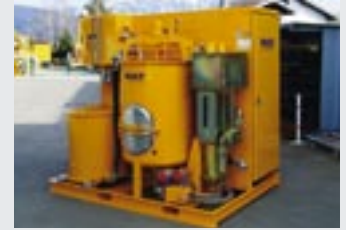
Injektionsanlage IPA-180-E mit autom. Zementdosierung Injection Plant IPA-180-E with automatic cement dosage
