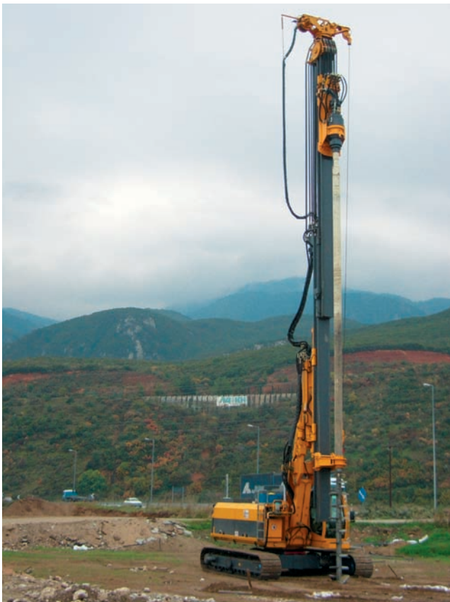
Bodenmischen mit Einzelpaddel an RG 16T, Griechenland Single column mixing with RG 16T, Greece
