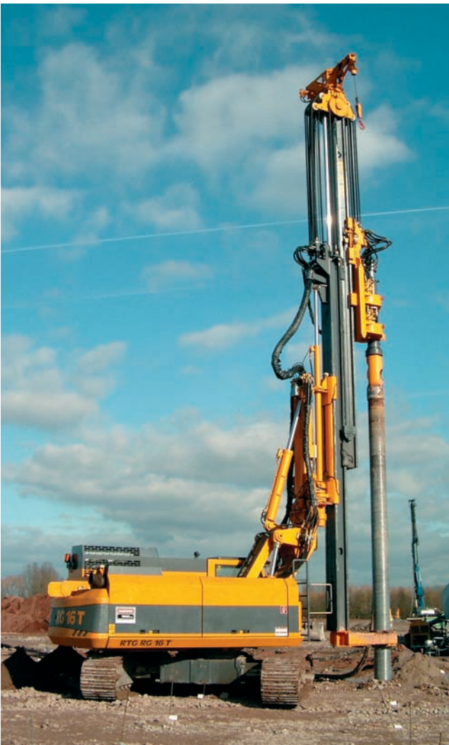
RG 16T mit Doppelkopfborantrieb VdW 6035, Chester, UK RG 16T with twin rotary drive VdW 6035, Chester, UK
