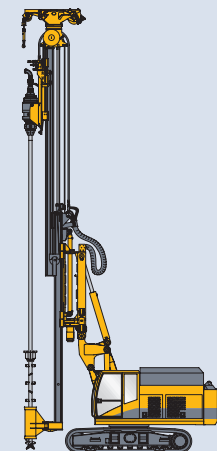
SCM Bodenmischen mit Einfachpaddel Single Column Mixing
