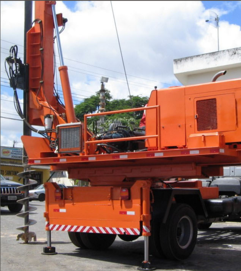
Hidraulic swing and sliding plataforma - Giro hidraulico e plataforma deslizando
