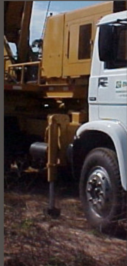
Four hidraulic jacks - Quatro patolas hidráulicas
