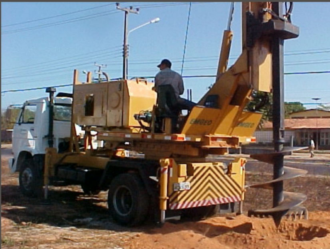
Triple telescopic kelly bar - Haste telescópica tripla
