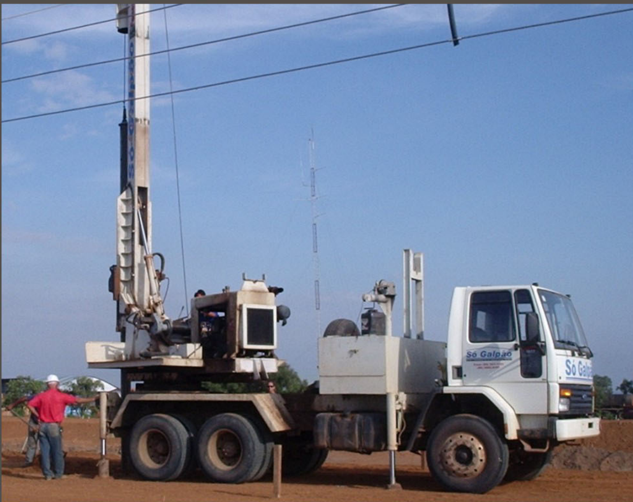
Hidraulic swing and sliding plataforma - Giro hidraulico e plataforma deslizando
