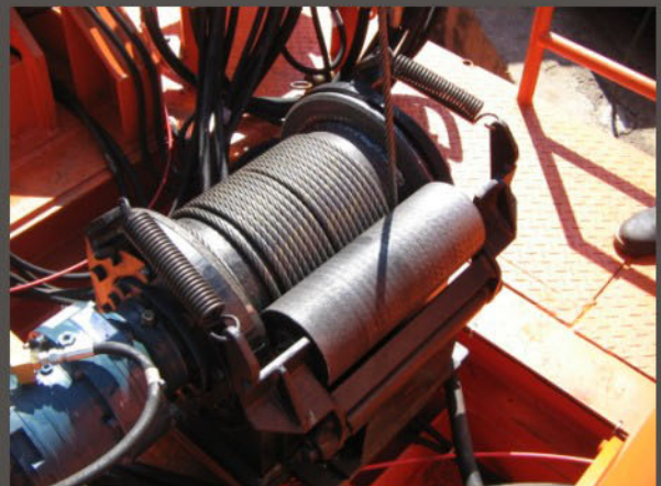
Hidraulic winch detail - Detalhe do guincho hidráulico
