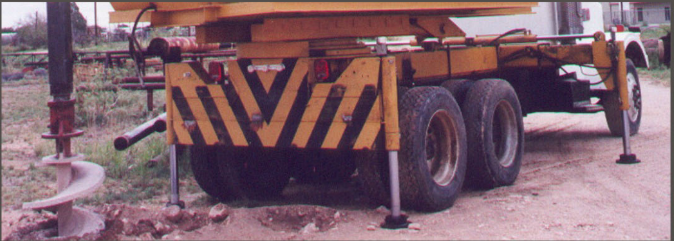
Hydraulic extendable rear jacks - Patolas traseiras extensíveis hidraulicamente
