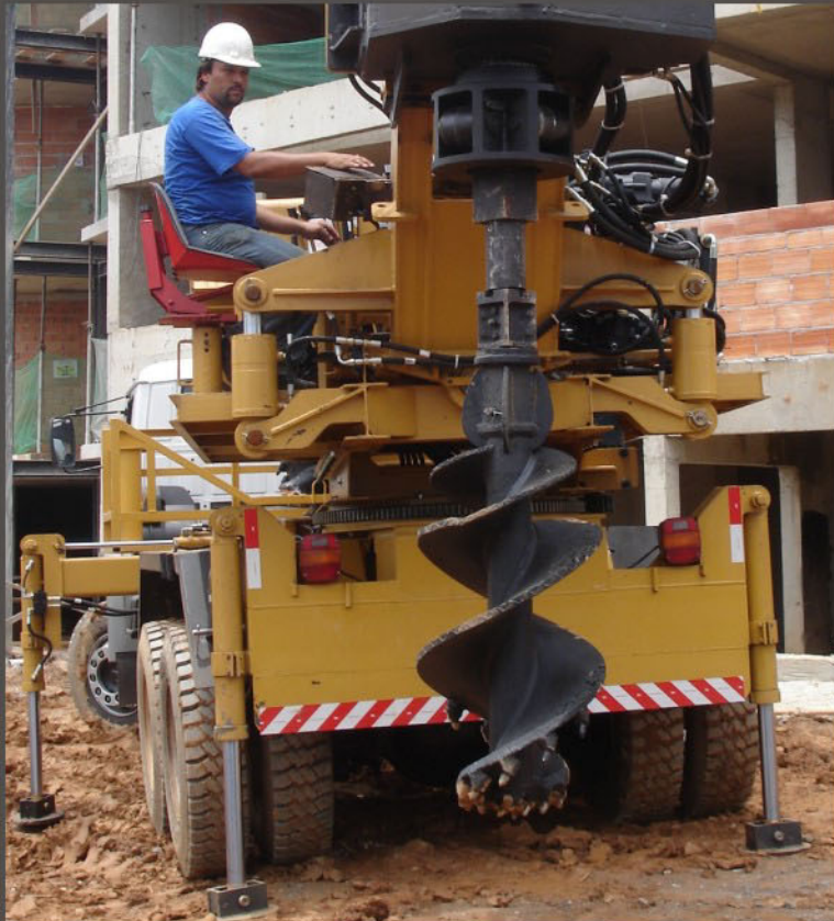
Besides four hidraulic jacks, there are two mast side levelling cilynders Além de quatro patolas ,dois cilindros laterais de nivelamento da torre
