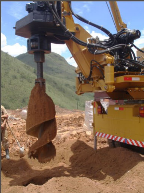
Short mast version for transmission lines - Versão com haste curta para linhas de transmissão
