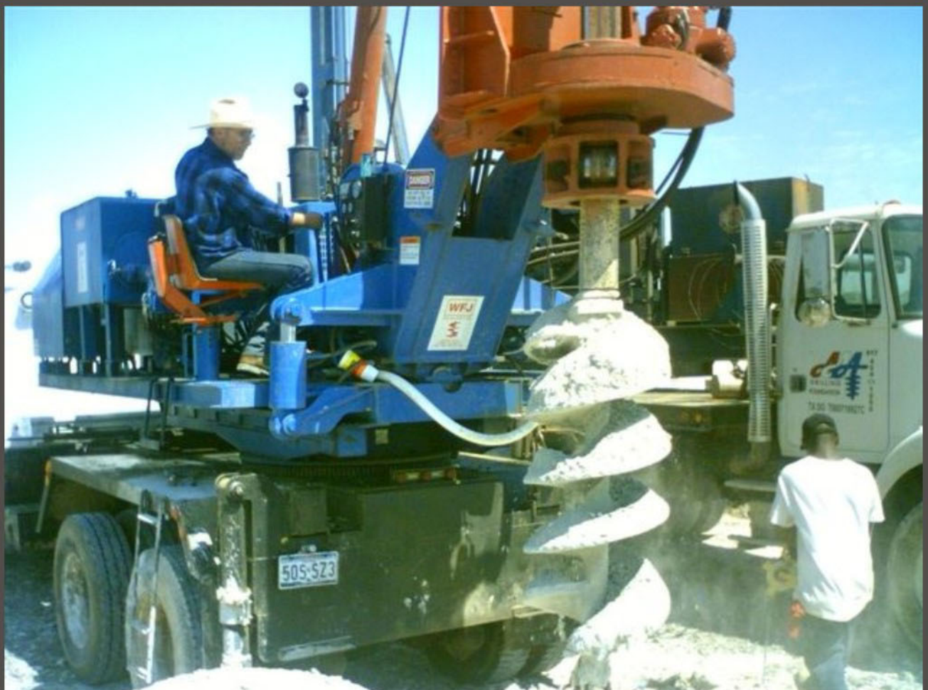
Roller Nest for kelly bars - Roletes de transmissão de torque Suitable for rock drilling - Adequado para perfurações em rocha Operating in USA
