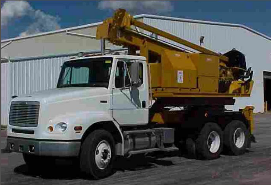
Short mast version for transmission lines - Versão com haste curta para linhas de transmissão
