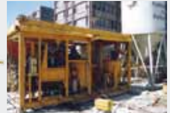
Vollautomatische, funktgesteuerte Injektionsanlage mit Chargenmischer SC-250 u. Injektionspumpe PP-180 Fully automated, radio controlled Injection Plant with Batch Mixer SC-250 and Injection Pump PP-180
