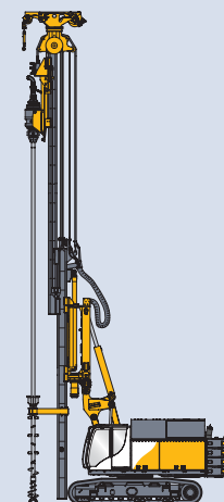
SCM Bodenmischen mit Einfachpaddel Single Column Mixing
