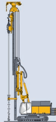
SCM Bodenmischen mit Einfachpaddel Single Column Mixing
