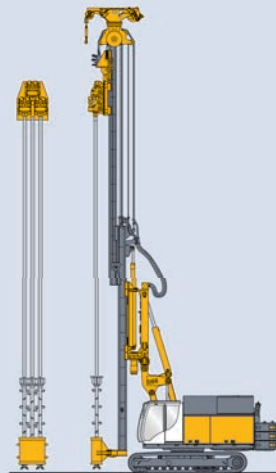
SMW Bodenmischen mit Dreifachpaddel Soil Mixing Wall System
