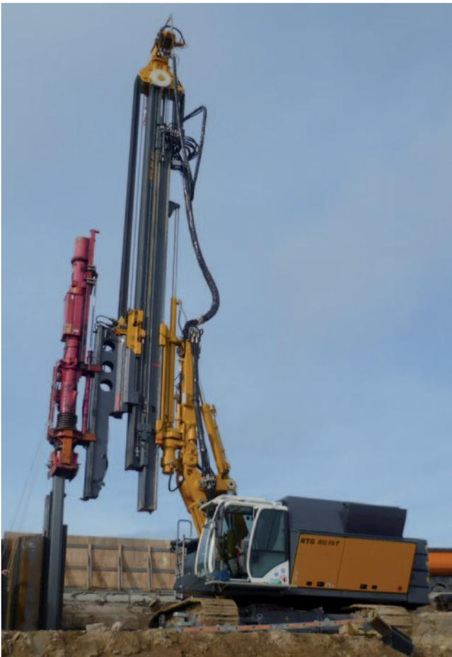
RG 19 T mit Dieselhammer zum Einbringen von Spundwänden
