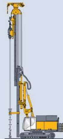
SCM Bodenmischen mit Einfachpaddel Single Column Mixing
