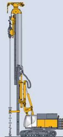
SCM Bodenmischen mit Einfachpaddel Single Column Mixing
