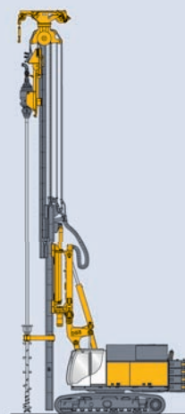
SCM Bodenmischen mit Einfachpaddel Single Column Mixing
